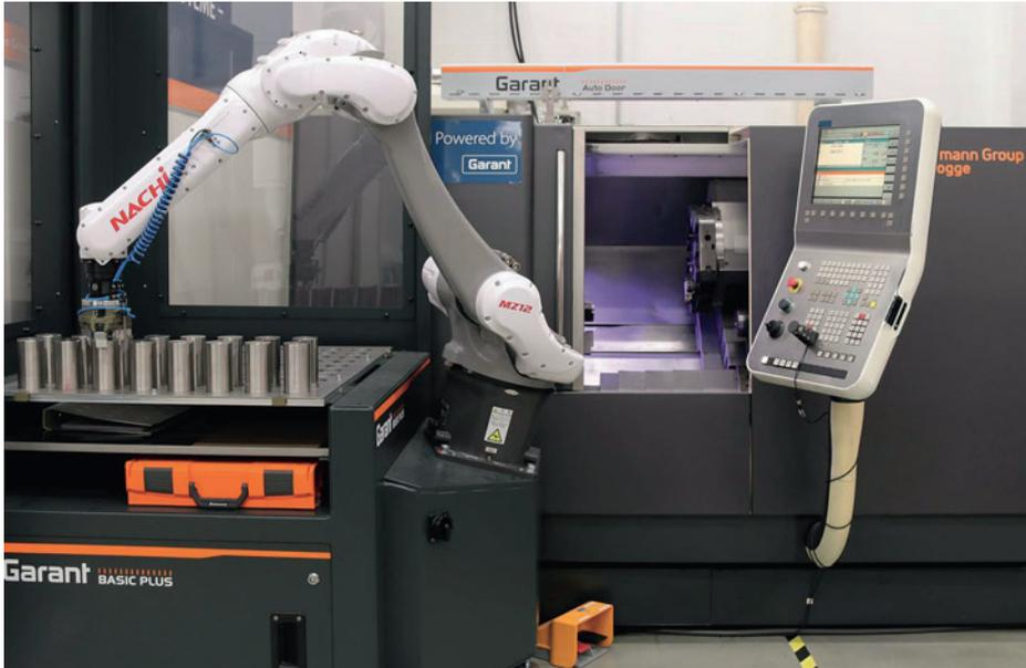
Der neue Bestückungsroboter ermöglicht die Erhöhung der Kapazitäten.
